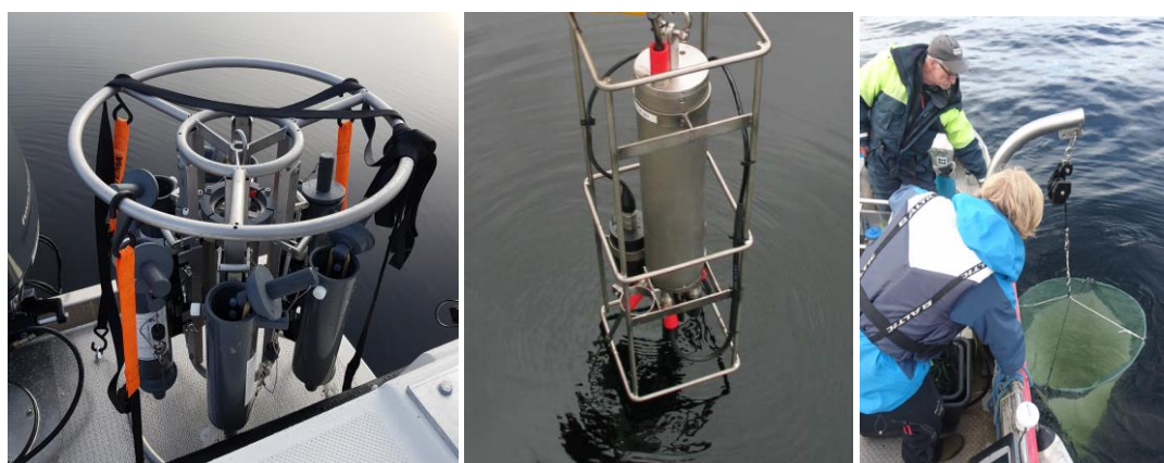
Figur 2. Båt fra Trolling Adventure med løftekran og motorisert linehaler, samt nytt feltutstyr brukt i 2017: fra venstre mot høyre: Rosett-samler med 6 prøveflasker, multisensor-sonder for måling av vertikalprofiler, Mysis-håv for dyreplanktonprøver fra hele vannsøylen.
