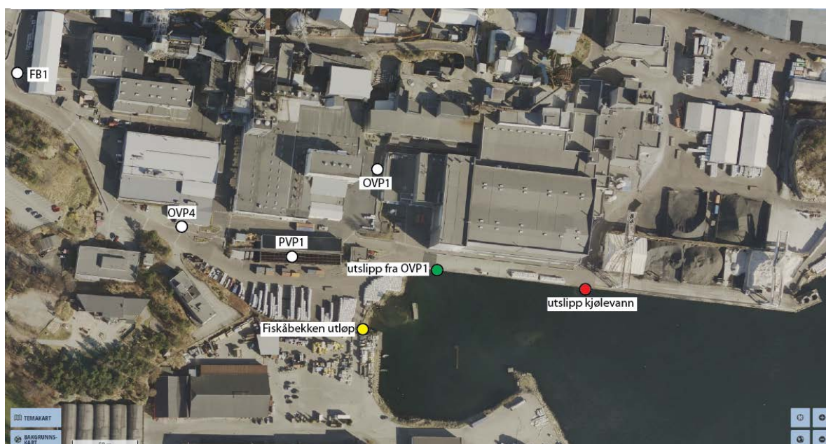
Figur 8. Utslipp fra overvannsledning fra bedriftsområdet til Elkem Carbon AS er vist med grønn sirkel. Målepunkter for PAH-forbindelser i vann fra overflateutslipp er merket OVP1 og OVP4. I
