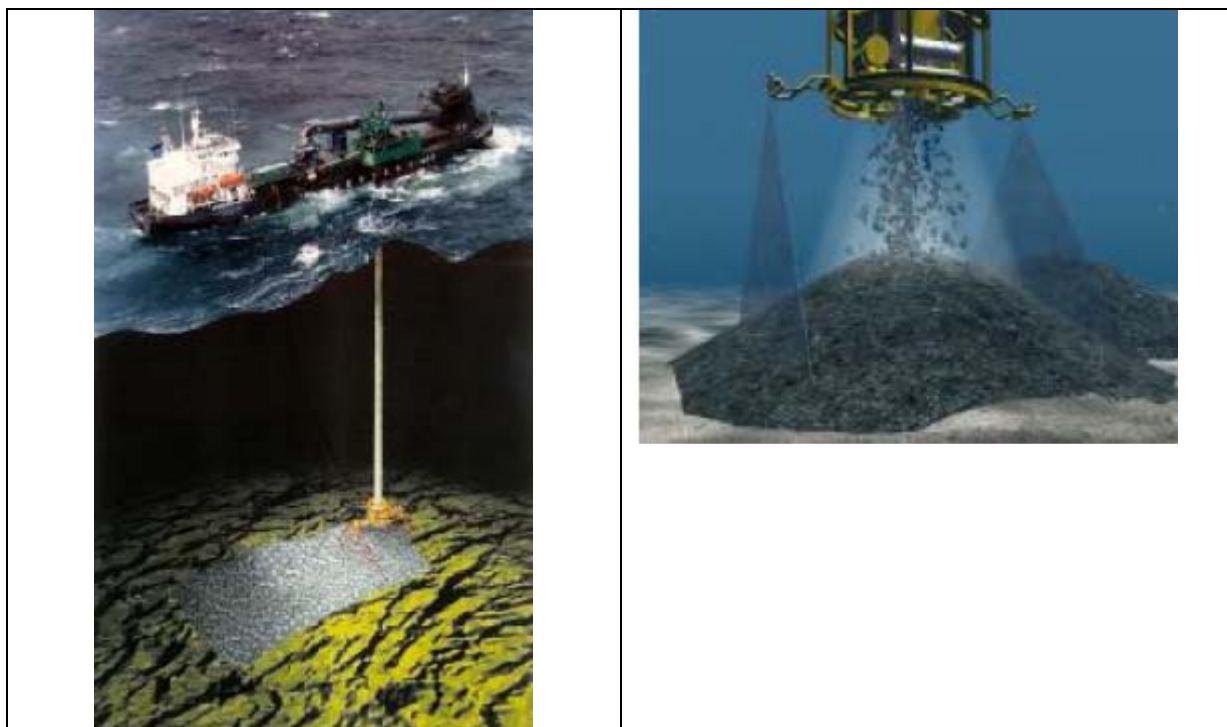
Figur 8. Utlegging av dekkmasser (bilde: Van Oord-rapport til KyD).
