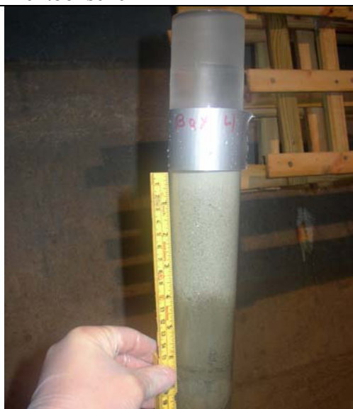
Figur 13. Kjerne med tildekkingslag over det kvikksølvforurensede sedimentet.
