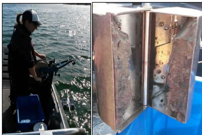
Figur 3 Prøvetaking med van Veen-grabb (0,025 m 2 ) i Rognsfjorden 28.august 2018. Høyre bilde viser et eksempel på de sandige sedimenter som dominerer i trasé-området.
