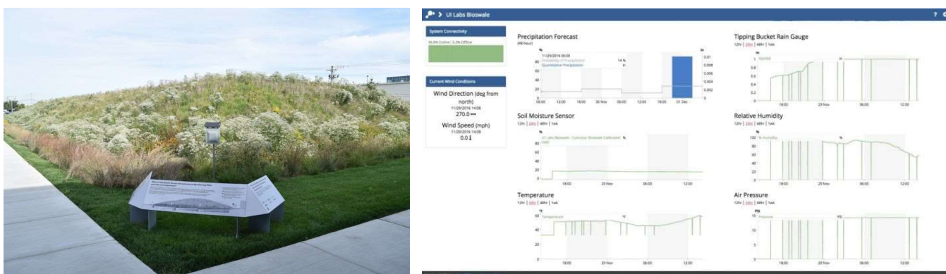
Figur 24. Smart Green Infrastructure Monitoring (SGIM)-prosjektet i Chicago har etablert smarte sensorer og på steder rundt om i byen som del av en pilot. Kilde: City Digital, Chicago.
