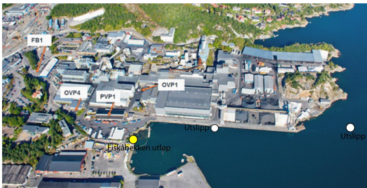
Figur 2. Utslipp fra Elkem Carbon AS går via Fiskåbekken som vist med gul sirkel. Utslippspunkter for REC Solar Norway AS er vist med hvit sirkel. Utløpet av Fiskåbekken med prosessvann (PVP1) er vist med gul sirkel. Viktigste punktavløp for overflate vann er OVP1 og OVP4. FB1 angir Fiskåbekken (Kilde: Bente Sundby Håland, Elkem Carbon AS).
