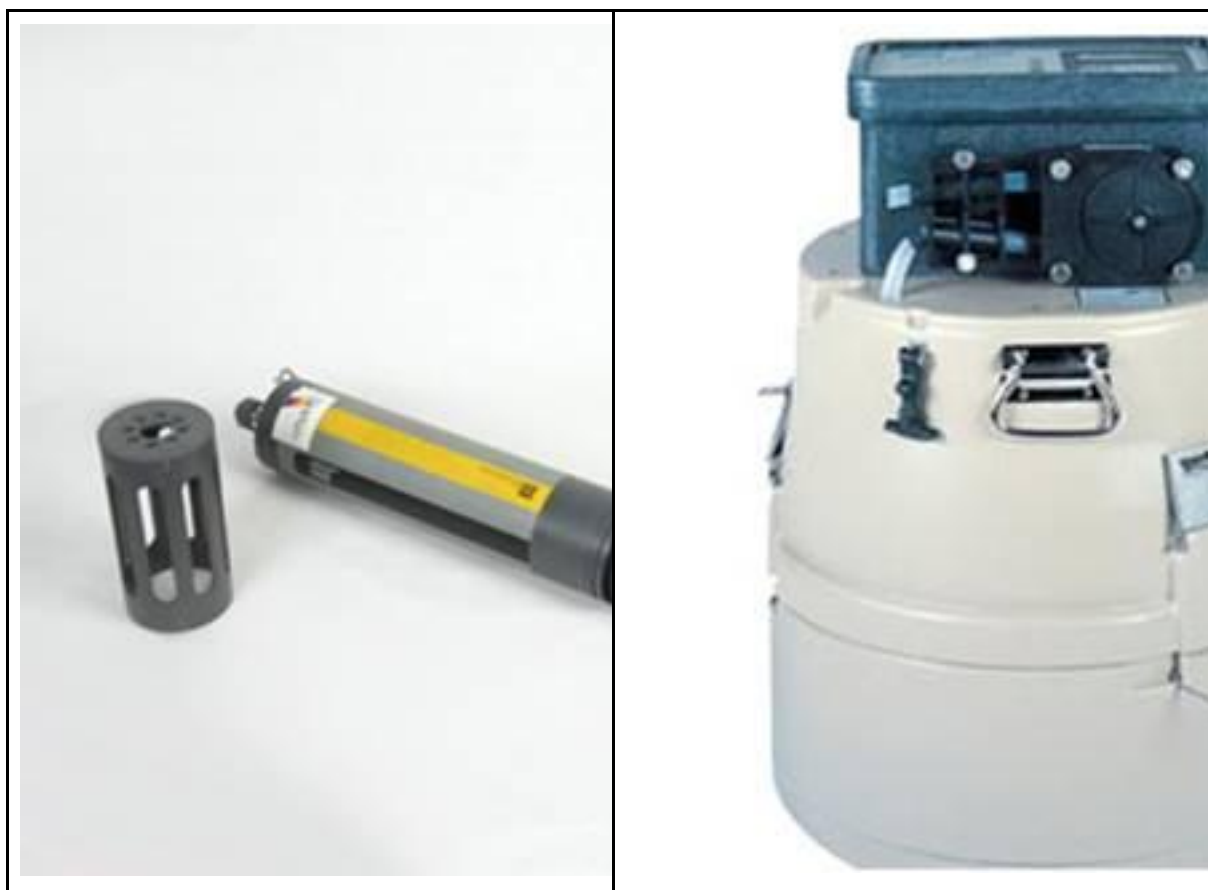
Figur 33. Eksempel på måleprobe (til venstre) som kan bestykes med en rekke vannkvalitetssensorer. Automatisk prøvetaker (ISCO) for feltbruk er vist til høyre.
