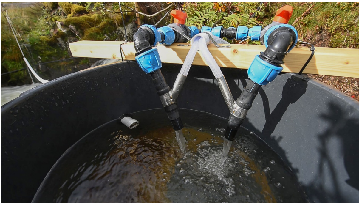
Figur 5. Kjemikaliene ble pumpet til blandkaret gjennom hver sin slange. Like før kjemikaliene nådde blandkaret ble de fortynnet med elvevann via en y-kobling som vist på bildet. Kjemikaliene ble blandet sammen i blandkaret, og i denne prosessen ble det dannet monokloramin som ble ledet ut i elva. Foto: Anders Gjørwad Hagen/NIVA
