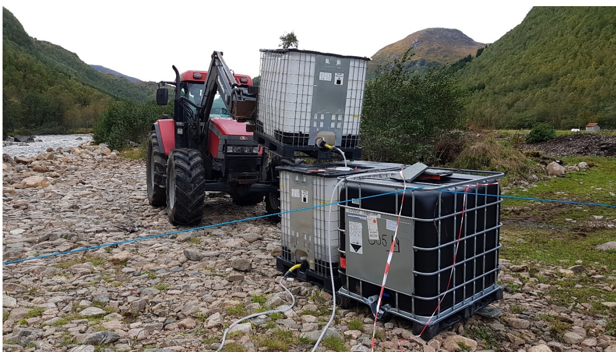
Figur 7. IBC-tanker med kapasitet på 1000 l ble transportert frem til doseringspunktene med traktor. Foto: Tobias Holter/NIVA
