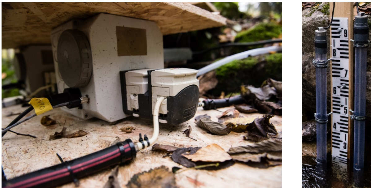
Figur 6. Vannstandsmålere (høyre) og peristaltiske pumper (venstre) brukt til vannføringsstyrt dosering av kjemikaliene. Foto: Anders Gjørwad Hagen/NIVA
