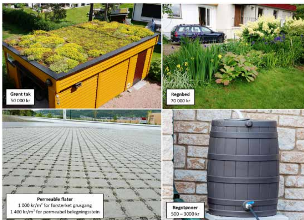
Figur 1 Illustrasjon av LOD-tiltakene grønt tak, regnbed, permeable flater og regntønner, samt etablerings- og innkjøpskostnader. Beløpene ble brukt som eksempler for etablerings- og innkjøpskostnader i spørreundersøkelsen. Foto: Bent Braskerud (grønt tak og regnbed), Aaltvedt Betong AS (permeable flater), og Aqua Mechanical 1 (regntønner).
