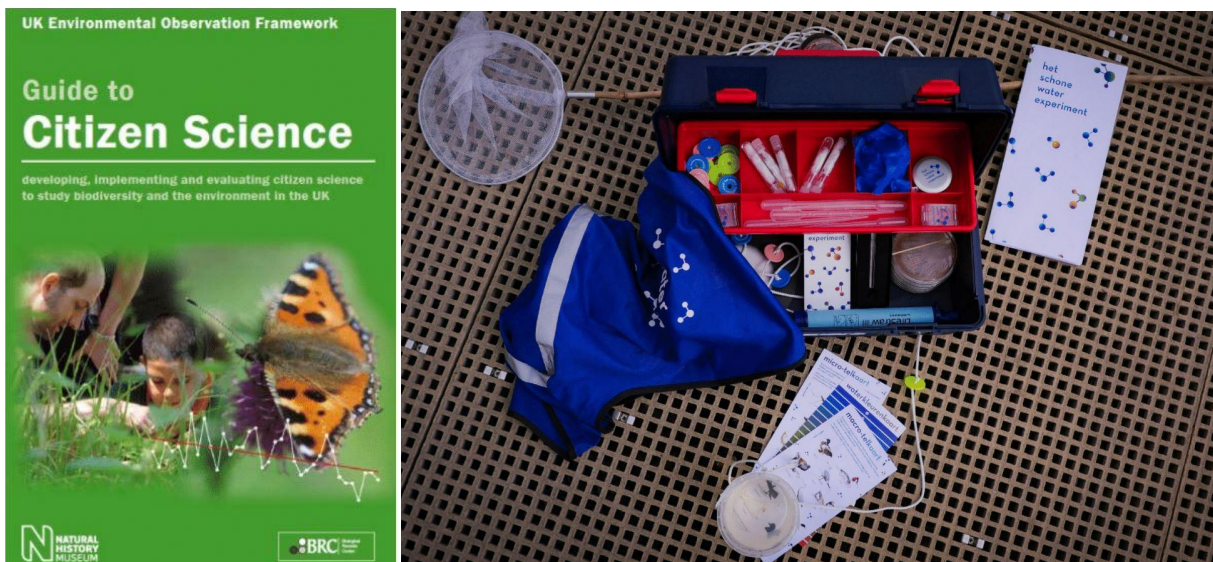
Figur 5. En håndbok som er laget i UK for involvering av innbyggere i samfunnsaktiviteter 3 . Profesjonelt opplegg skaper interesse: «Vannkasse» med utstyr for å måle alger og bakterier, vekst av vannplanter, vannfarge og -dybde og hvilke stoffer som forekom i vannet. Den blå vesten som fulgte med, ble svært populær og bæreren viste med den et samfunnsengasjement (Slide: G. Mol).
