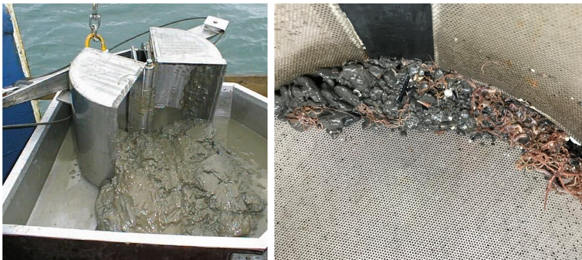
Figur 1 Van Veen-grabb (venstre) som benyttes til prøvetaking av bløtbunnsfauna og sikterest (høyre) fra stasjon TØ1 med bunnfauna (mye slangestjerner i dette tilfellet) og leirerester. Foto: NIVA
