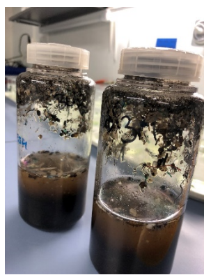
Figur 7: Ekstraksjon av «elutriat». Legg merke til små plastpartikler i vannoverflaten. Foto: NIVA
