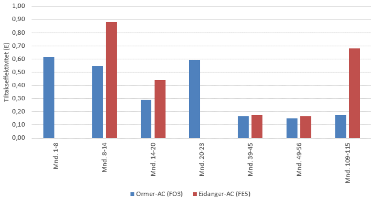
Figur 19. Flukser av dioksiner (PCDD/F-TEQ) presentert som tiltakseffektivitet for testfeltene dekket til med AC/leire (FO3 og FE5). Figuren viser svært god tiltakseffektivitet i begge fjordene i mnd 39-45 og 49-56. (OBS manglende data, se kap. 3.2.2.)
