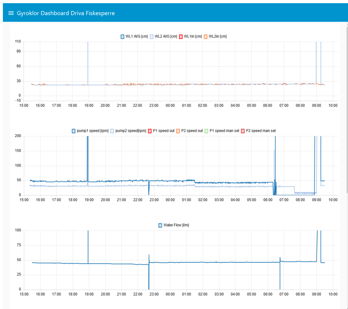
Figur 10. Et kontrollpanel på PC viste de ulike parameterne som var relevant for doseringen. Vertikale utslag skyldes restart av systemet etter justering av dose.
