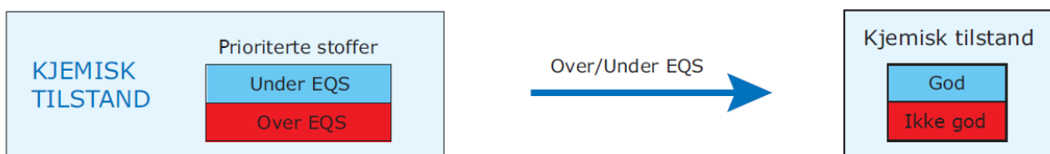
Figur 6. Prinsippskisse for bestemmelse av kjemisk tilstand.
