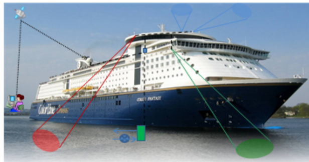
Figur 2. MS Color Fantasy illustrert med dekkssensorer for lys (blå), havfarge (grønn), overflatetemperatur (rød), kommunikasjon til land og FerryBox systemet omtrentlig plassering i fartøyet.
