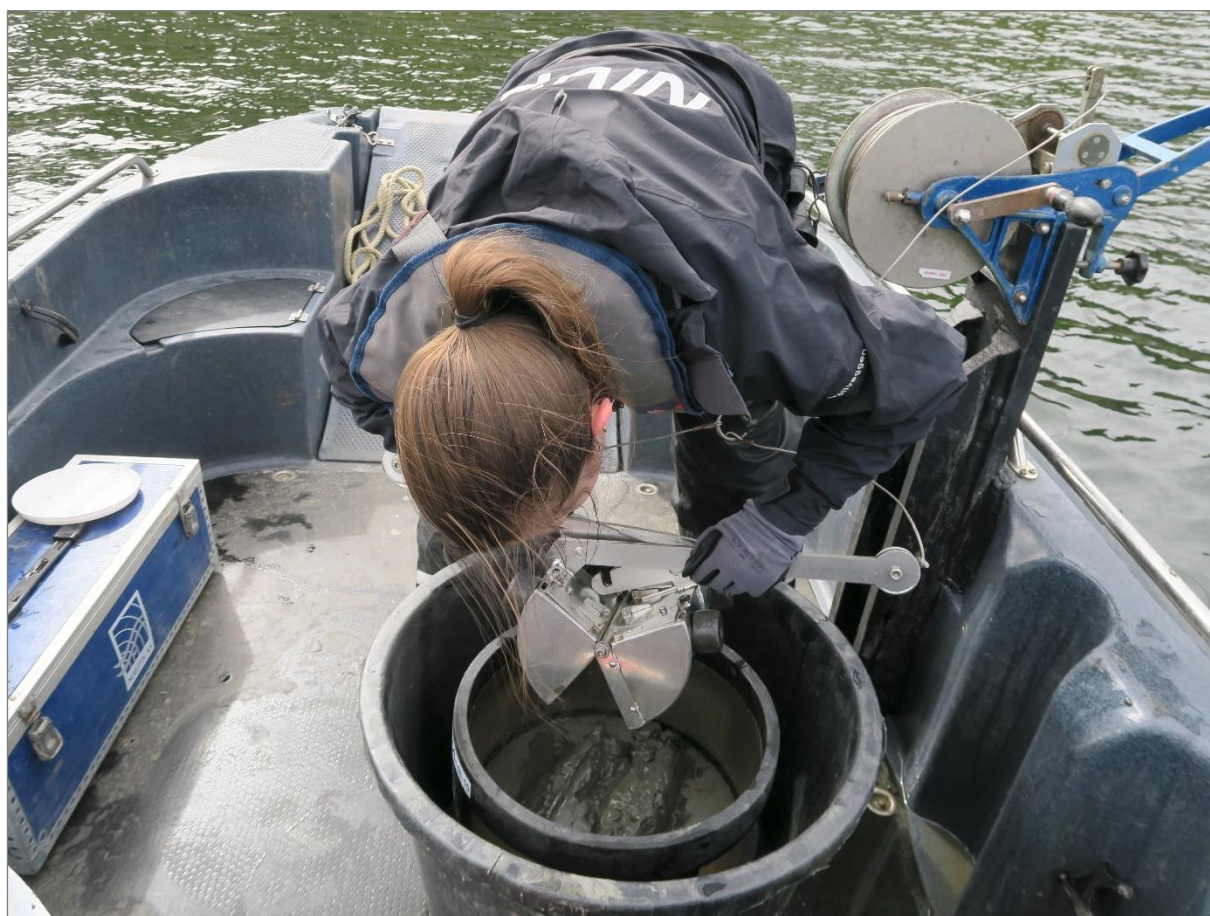
Figur 7. Prøvetaking av bunnsedimenter med håndholdt van Veen-grabb.
