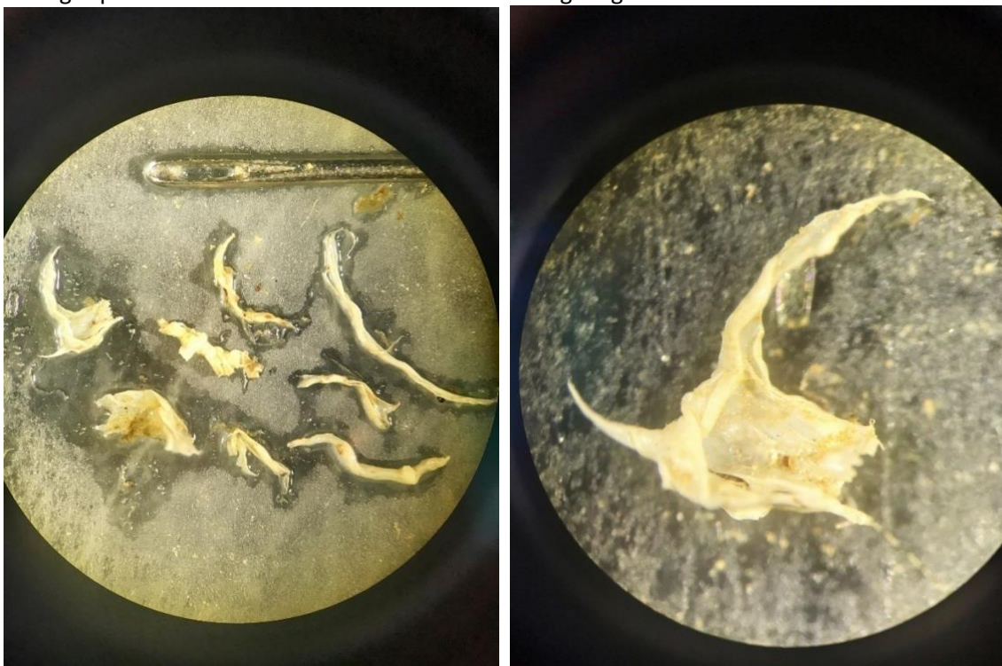
Utvalgte plastbiter funnet ved F10 (Gjelten bru). Minste ca. 2 mm og Største/lengste ca. 6 mm.
