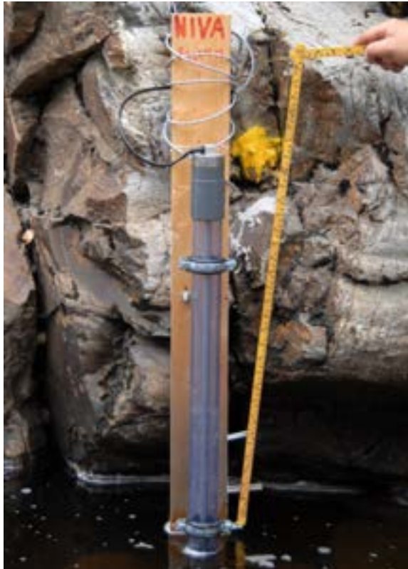
Figur 12. Nullpunktet i fjellet er satt med ekspansjonsbolt, er merket med gul spray og ses mellom tommestokk og stav.
