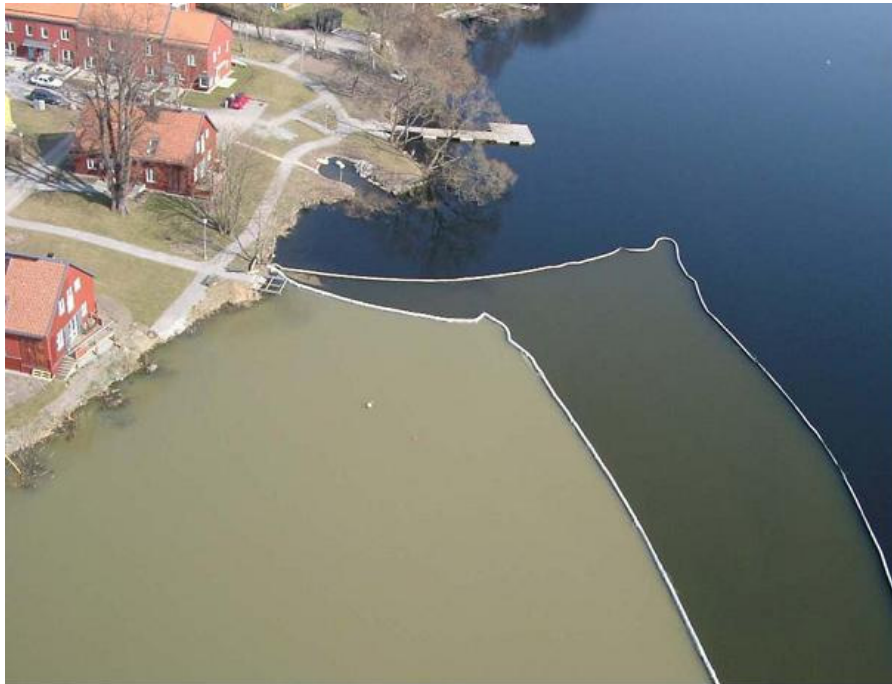
Figur 9. Fotografi som viser effekten av bruk av siltskjørt tilknyttet mudringsarbeid (Sundqvist 2006).
