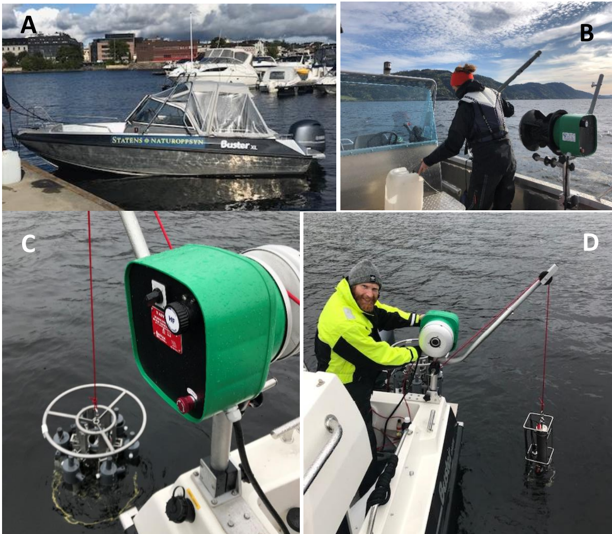
Figur 2. A) Båten fra SNO er utstyrt med løftekran og motorisert linehaler som er egnet til håndtering av tungt feltutstyr, f.eks. rosett-prøvetaker med 6 vannprøveflasker (C) og multisensor-sonde for måling av vertikalprofiler (D). NIVAs egen båt (B) er utstyrt med tilsvarende linehaler og løftekran. Fotos: NIVA. Personer i bildet: B) Henriette Kildahl og D) Jan-Erik Thrane, NIVA.
