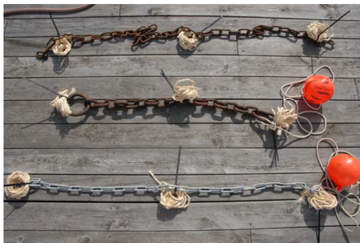
Figur 3. Feller for innsamling av bunnlevende organismer. Kjetting med kveiler av hamptau plasseres på bunnen og markeres på overflaten med bøye. Foto: Marianne Olsen, NIVA.
