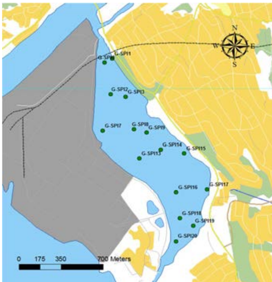
Figur 5. SPI-stasjoner i Gunneklev i oktober 2013. Kameraet overpenetrerte stasjon 2 – 14 og 16, som alle er plassert i de sentrale områdene av fjorden, på grunn av løst bunnsbunnsstrat. Kart: Bjørnar Beylich, NIVA.
