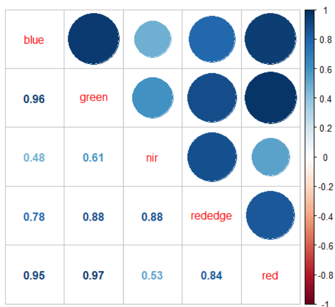
Figur 6. Oversikt over samvariasjon mellom variabler beregnet ved Pearsons korrelasjonstest. (0 = ingen samvariasjon, 1 = perfekt samvariasjon, -1 = motsatt samvariasjon). Kanalen «nær-rød» viste så sterk samvariasjon med samtlige resterende variabler at den ble kuttet ut i modelleringsarbeidet.
