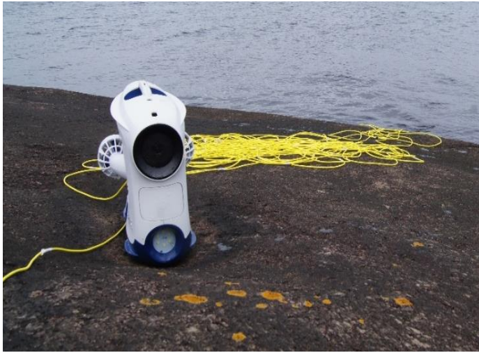
Figur 15. Undersøkelser i sjøsonen ble gjort med en fjernstyrt BluEye mini-ROV.
