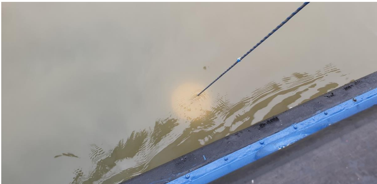
Figur 48. Måling av sikten i vannet med en siktskive. I dette tilfellet var det liten sikt og brunt vann. Målingen er fra stasjon Gp2 i Bunnebotten den 10. februar 2020.
