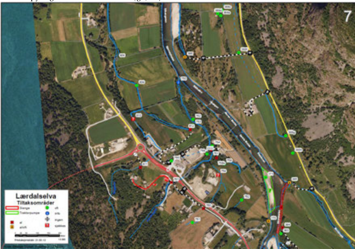
Områder (grønn og rød ramme) ved Skolehølen/Tønjum der det ble gjennomført ekstra doseringstiltak i form av kontinuerlig overrissing med AIS-tilsatt vann fra perforerte slanger (rød) eller overspyling med AIS-tilsatt vann (grønn).
