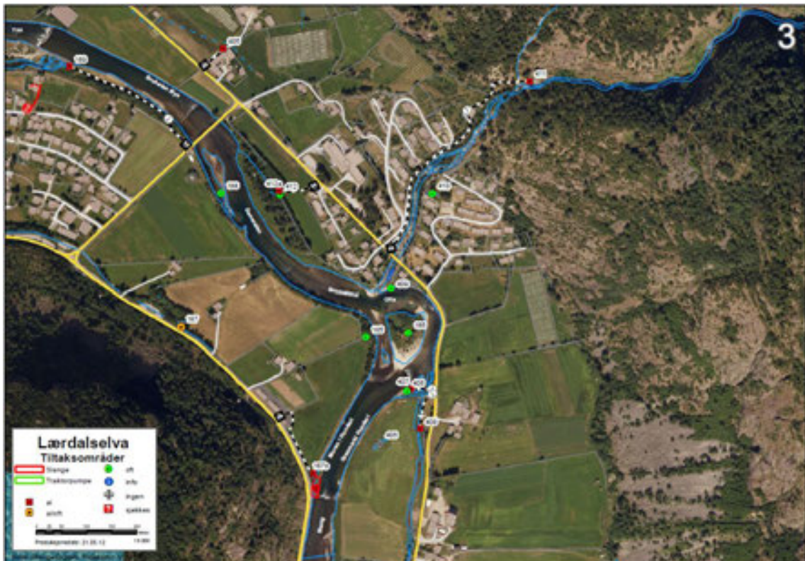
Et område (rød ramme) ved Hunderi der det ble gjennomført ekstra doseringstiltak i form av kontinuerlig overrisling med ALS-tilsatt vann fra perforerte slanger.
