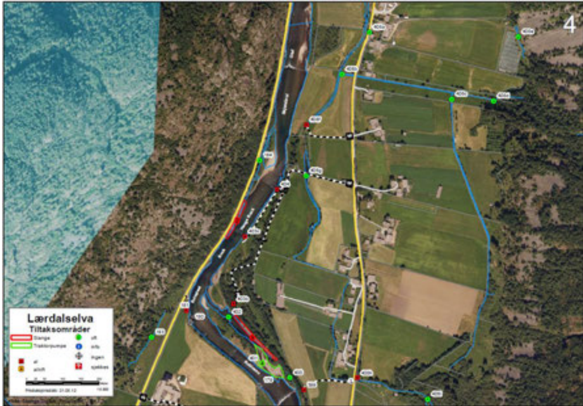
Områder (grønn og rød ramme) ved Hauge/Robinson og Rock der det ble gjennomført ekstra doseringstiltak i form av kontinuerlig overrisling med ALS-tilsatt vann fra perforerte slanger (rød) eller overspyling med ALS-tilsatt vann (grønn).
