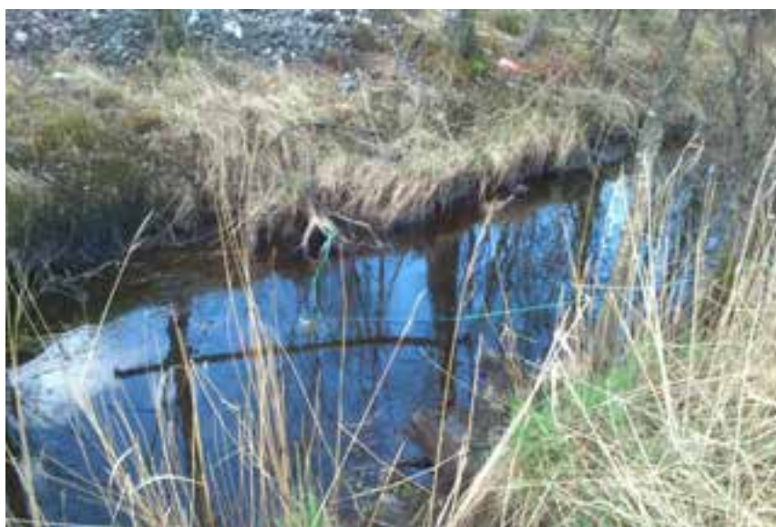
Figur 2. Stasjon 3, utløp av Kråvatn 9. april 2014. Bur med SPMD i elva forankret med tau. Foto A. Hobæk, NIVA.
