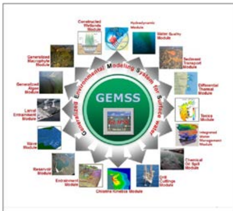
Figur 6. GEMSS er en pakke med modeller. I sentrum står en hydrodynamisk modell. Det er flere tilleggsmoduler, blant annet sedimenttransport og vannkvalitet.
