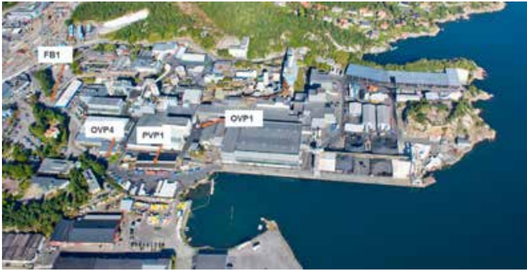
Figur 2. Utslipp av PAH med overflatevann målt i punkt OVP1 og OVP4 samt tilførsler fra Fiskåbekken (FB1). Utslippspunkt for prosessvann (PVP1) er også vist. Data er sammenstilt av Bente Sundby Håland, Elkem Carbon AS.
