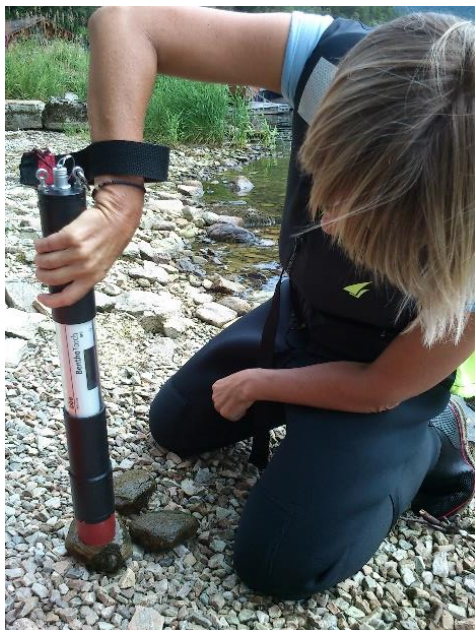
Figur 30. Måling av biomasse av påvekstalger med BenthoTorch. I dette tilfellet måles på tilfeldige stein plukket opp fra vannet, men måling kan også gjøres direkte under vann. Foto: A. Hobæk.
