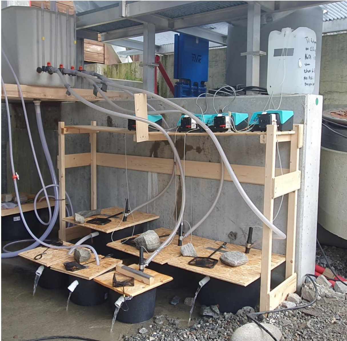
Figur 2. Bilde av forsøksoppsettet høsten 2020. Et overløpskar (øverst til venstre) sikret stabil vanntilførsel til karene i henholdsvis tålegrenseforsøket (bakre rekke av murstamper) og effektforsøket (fremre rekke). Pumper forsynte forsøkskarene med kloramin fra en felles doseringsløsning (oppe til høyre). Den høyeste konsentrasjonen i effektforsøket tilsvarte den laveste konsentrasjonen i tålegrenseforsøket, og disse fikk derfor dosert klor fra felles pumpe (venstre side i oppsettet). Foto: K. Olstad/NINA
