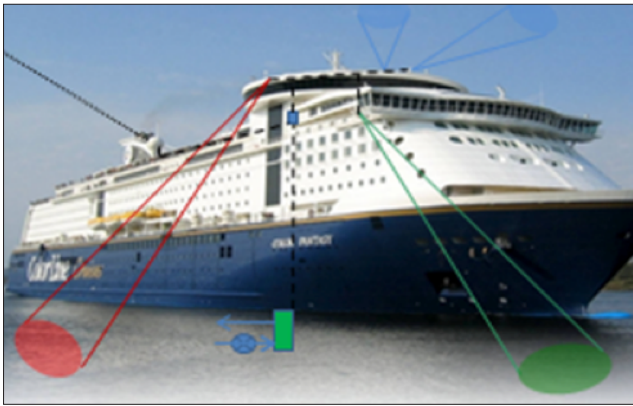
Figur 1. Overvåking med bruk av Color Fantasy. Sensorer i vann (Ferrybox) og på dekk, dataoverføring via satellitt.
