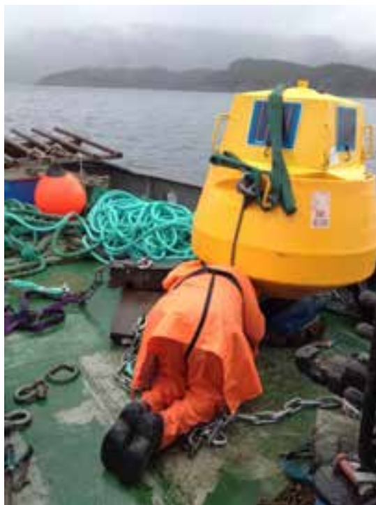
Figur 5. På bilde vises målebøya på dekk før utplussing.
