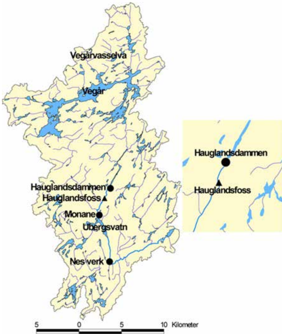
Figur 1. Storelva med nedbørfelt ( 457 \text{ km}^2 ), med plassering av kalkdoseringsanlegg (trekant) og pH- målestasjoner (sirkler).
