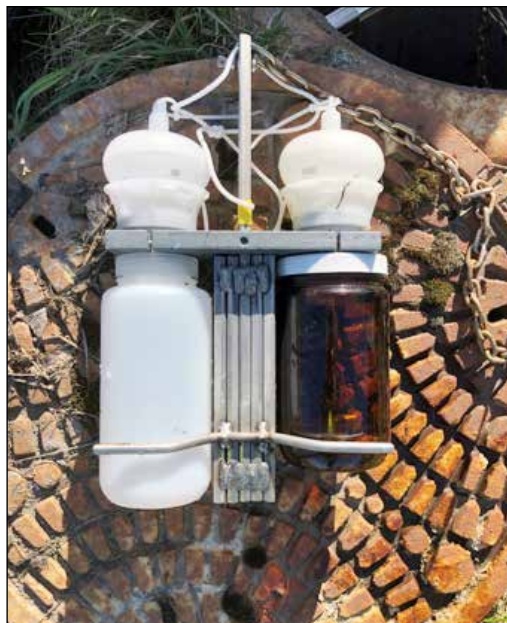
Figur 2. Bildet viser den passive vannprøvetakeren med selvlukkermekanisme (til høyre) og prøvetakeren installert i dreneringskum (til venstre). Den passive vannprøvetakeren har en flaske for uorganiske stoffer (plast) og en flaske for organiske forurensningsstoffer (glass). Flaskene rommer en liter, og lukker seg automatisk når flaskene er fylt opp.
