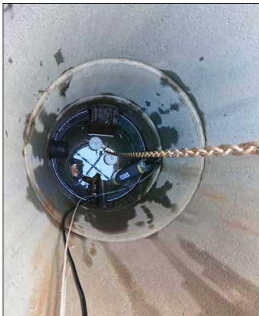
Figur 2. Bildet viser den passive vannprøvetakeren med selvlukkermekanisme (til høyre) og prøvetakeren installert i dreneringskum (til venstre). Den passive vannprøvetakeren har en flaske for uorganiske stoffer (plast) og en flaske for organiske forurensningsstoffer (glass). Flaskene rommer en liter, og lukker seg automatisk når flaskene er fylt opp.
