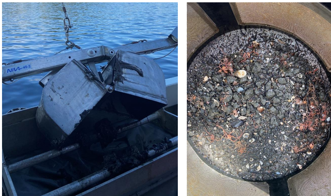
Figur 6. Van Veen-grabb (venstre) som benyttes til prøvetaking av bløtbunnsfauna, og sikterest (høyre) fra stasjon Z6 med bunnsfauna (bl.a. slangestjerner) og leirrester. Foto: NIVA
