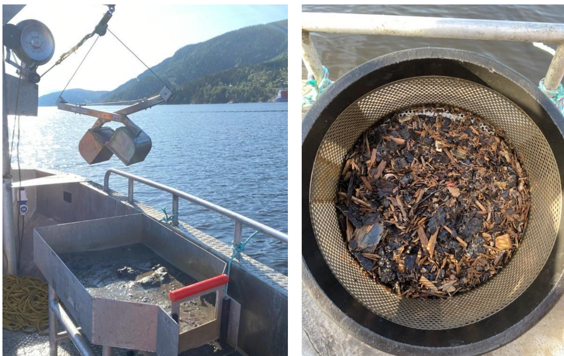
Figur 5. Van Veen-grabb (venstre) som ble benytte til prøvetaking av bløtbunnsfauna og sediment i Beitstadfjorden 2021, og sikterest (høyre) fra stasjon SCE6, hvor man kan se store mengder flis i sikteresten. Foto: NIVA
