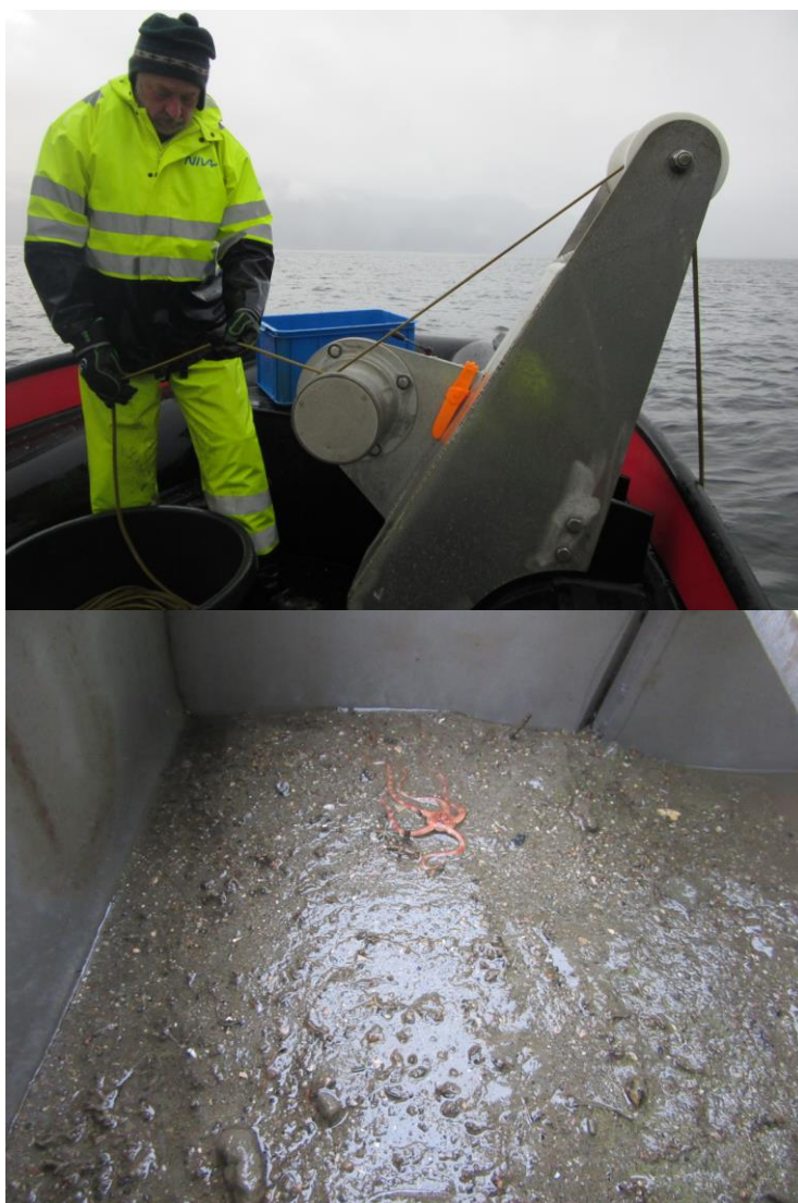
Figur 6. Bilder fra prøvetaking av sediment i Høyangsfjorden. Foto: Sigurd Øxnevad.
