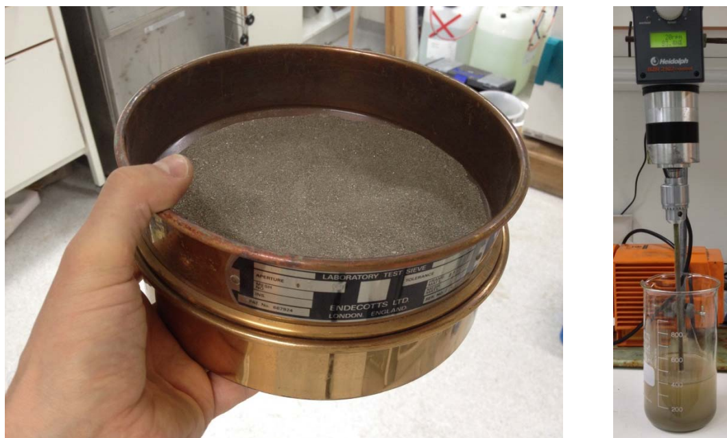
Figur 8. A) Sikting av avgang gjennom en sil med lysåpning på 63 \mu\text{m} og ned i en samleskål. B) Innblanding av restavgang med den flokkulerte finfraksjonen ved hjelp av bladomrører på rolig omrøring (20 rpm).
