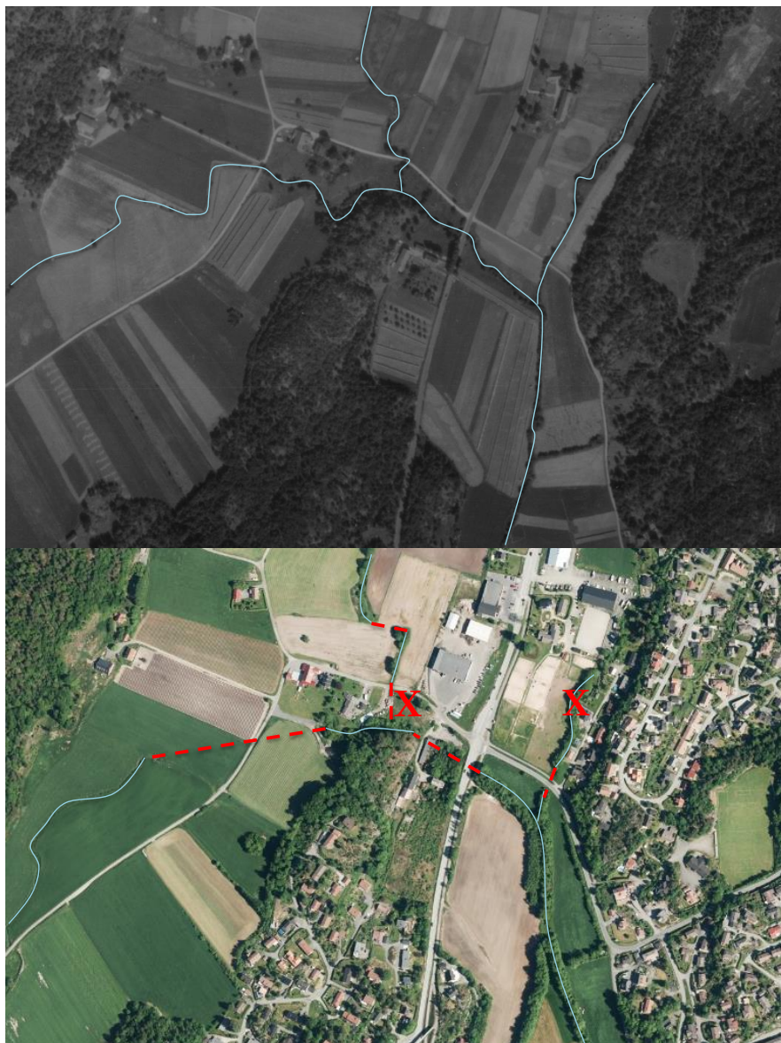
Figur 5. Det har vært betydelig bekkelukking i Nedenesbekken (rød stiplete linje) fra 1946 (øverst) til 2012 (Nederst) flere sidegreiner er også utilgjengelige pga feil kulvertdesign (røde kryss) (Statens kartverk).
