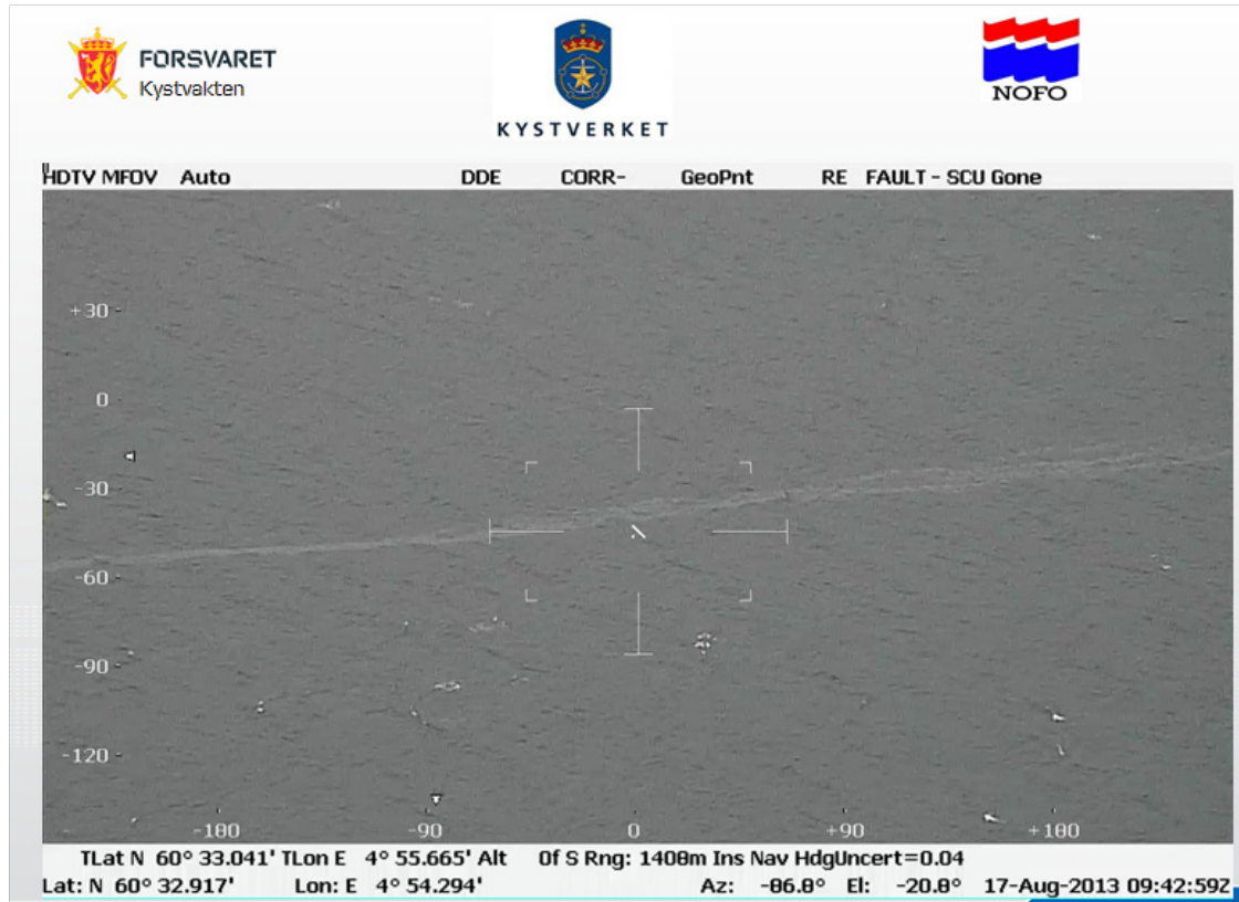
Figur 2: Flybilde tatt fra Kystverkets overvåkingsfly mens lekkasjen pågikk og som viser en smal og langstrakt oljefilm i sørlig retning omtrent midtfjords i Hjeltefjorden. Den svært smale og langstrakte formen på oljefilmen indikerer en sterk overflatestrøm.
