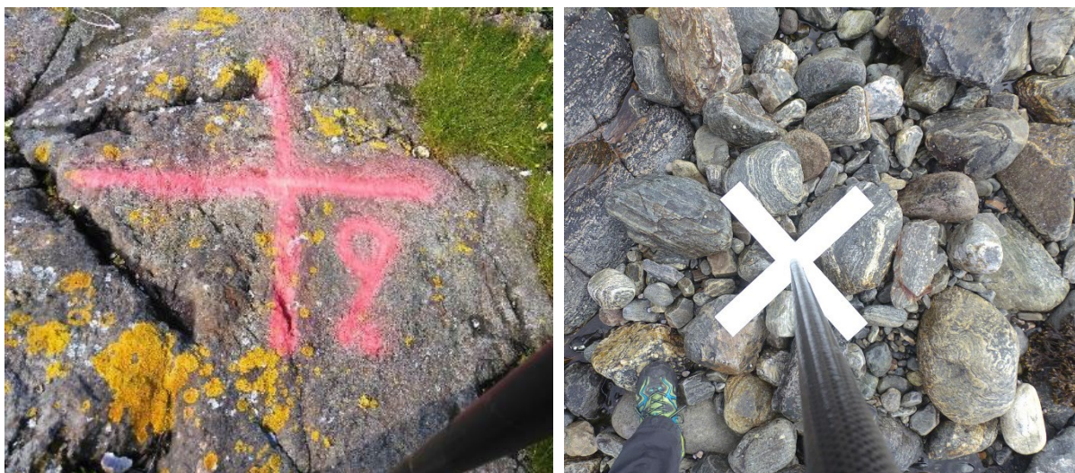
Figur 5. Kontrollpunkt (GCP) på bakken for å sikre riktig geoposisjonering av bildene. For markeringen ble det enten brukt en miljøvennlig, oppløselig kalkfarge som forsvinner i løpet av mindre enn 30 dager (A) eller et portabelt og gjenbrukbart trekryss malt med hvit maling (B).
