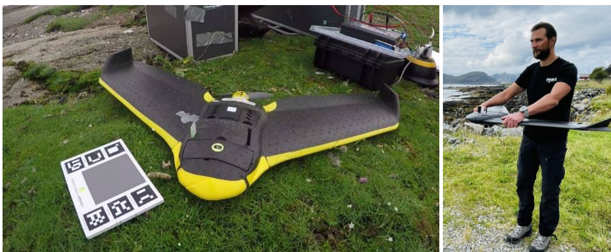
Figur 4. Fastvinge-dronen som ble anvendt i prosjektet – en eBee X mapping drone . Dronen var utstyrt med en multispektral sensor som samlet inn data i 5 spesifikke fargebånd (se Tabell 1 for detaljer).
