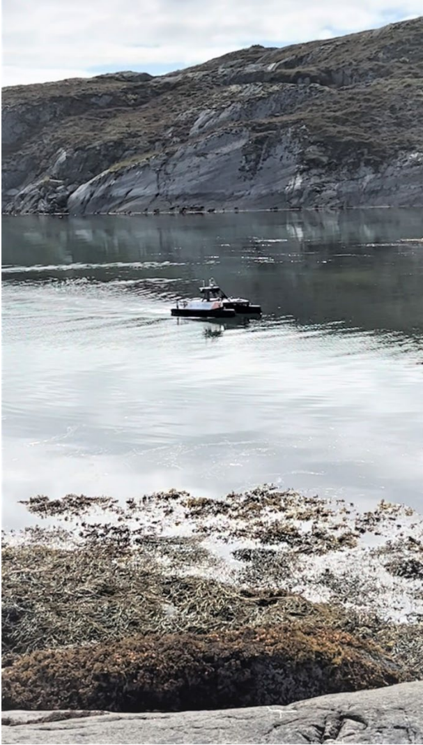
Figur 50. Den ubemanna farkosten Ottern i aksjon ved Søla nær Vega, utstyrt med gopro-kamera, sensorer for å registrere vannkvalitetsparametre, og ekkolodd for å kartlegge bunntyper.
