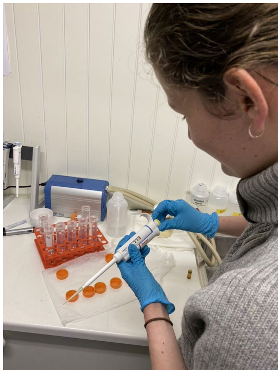
Figur 19. Standardene ble lagd ferske hver morgen og dannede beregningsgrunnlag for klorkonsentrasjonene som ble målt utover dagen. Foto: Anne Luise Ribeiro/NIVA.
