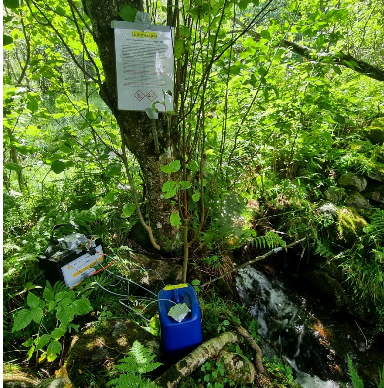
Figur 11. Oppsett for dosering av hypokloritt til sidebekk ved hjelp av piezopumpe. Foto: Kjetil Olstad.
