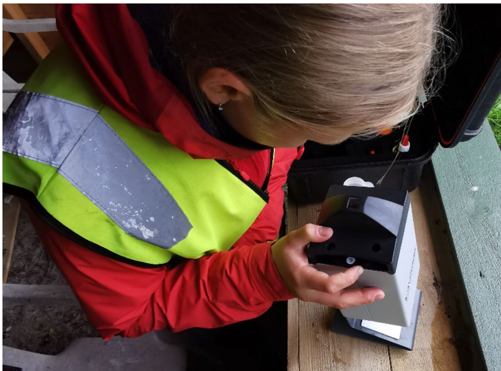
Figur 20. Avlesning av estimert klorkonsentrasjon ved hjelp av komparator. Foto: Åge Flakk
