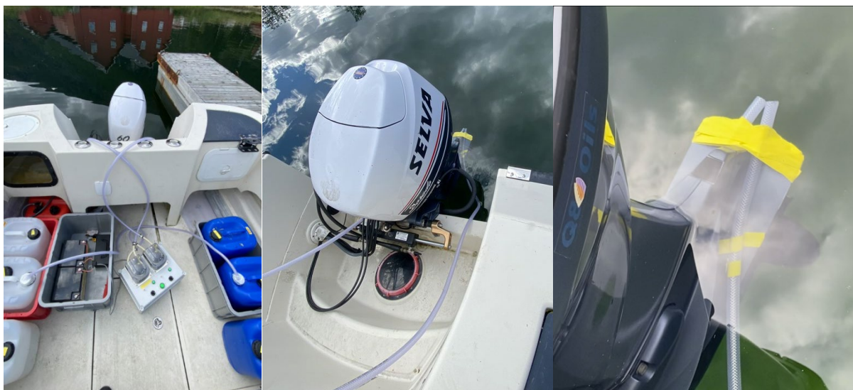
Figur 14 - Oppsettet som ble brukt for å dosere kloramin i båthavna. Foto: Anne Luise Ribeiro
