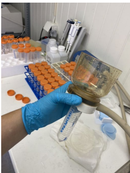
Figur 18. Hver vannprøve ble filtrert til tre sentrifugerør gjennom et membranfilter ved bruk av en vakuumpumpe før tilsetning av reagenser. Foto: Anne Luise Ribeiro/NIVA.
