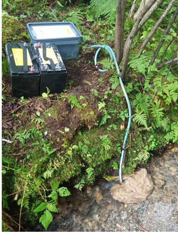
Figur 10. Oppsett for blandestasjon hvor hypokloritt og ammoniumklorid ble blandet på stedet før dosering til sidebekk. Foto: Roman Schlosser.
