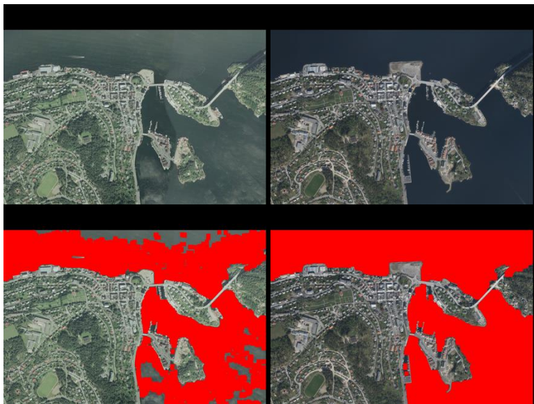
Figur 17. Bilder fra Farsund. Bildene til venstre og høyre tilsvarer henholdsvis årene 2002 og 2014. De øverste og nederste bildene er henholdsvis før og etter segmenteringen. Rødfargen representerer areal klassifisert som vann.
