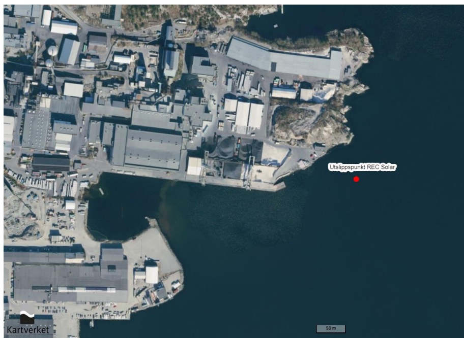
Figur 3. REC Solar har utslipp av avløpsvann på 23 meters dyp, 53 meter fra land.
