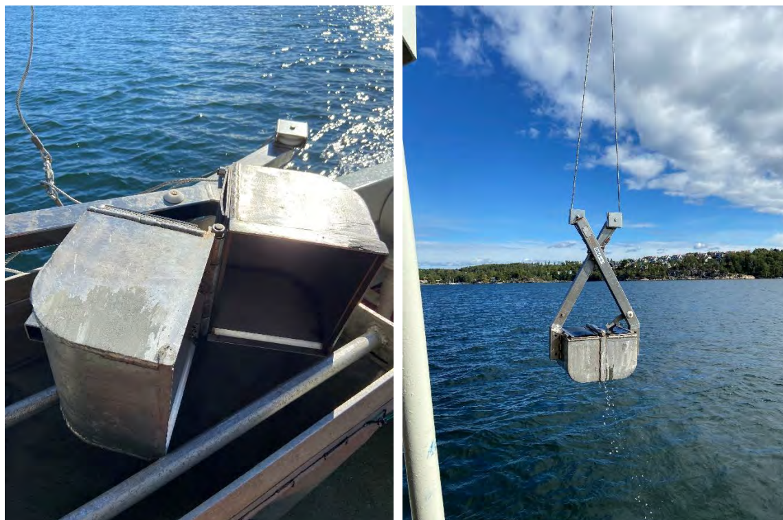
Van Veen grabb som ble benyttet til prøvetaking i Mossesundet.
