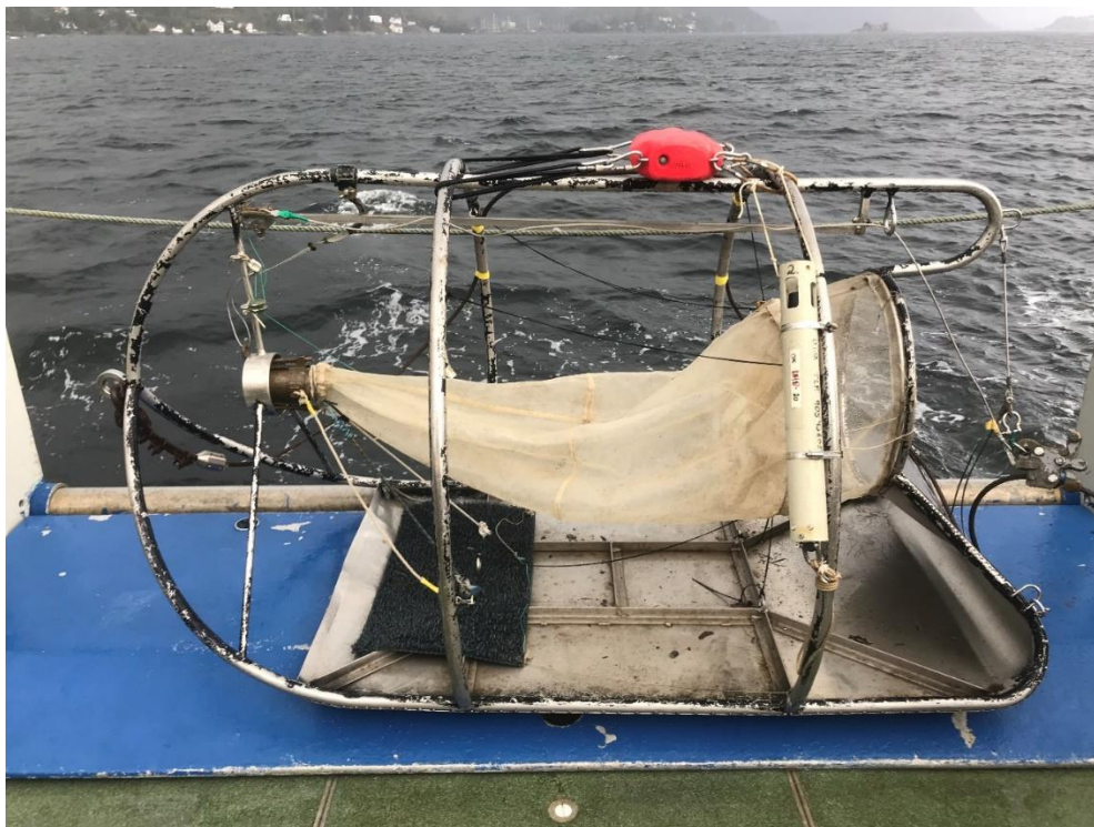
Figur 54. Beyer-sleden som ble brukt for prøvetaking av hyperbentos (reker) på lokalitetene i Indre Oslofjord i 2022. Foto: NIVA
