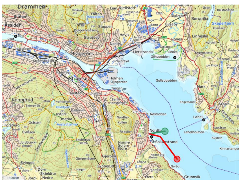
Figur 2. Kart over Drammensfjordens innerste del som viser mulige utslippsledninger. Den grønne ledningen er 700 m lang og går ut til 78 m dyp. Den røde ledningen er 1,7 km lang og går ut til 90 m dyp. De svarte punktene er utslippspunktene til dagens rensanlegg.
