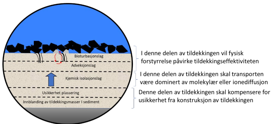
Figur 19. Konseptuell oppbygging av tildekking på forurenset sjøbunn.
